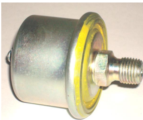
Рис.56. Датчик указателя давления масла
