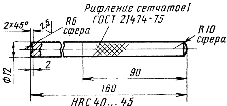
Рис. 43. Боек для запрессовки заглушек в отверстия под пружину стопорного шарика в корпусе коробки передач
