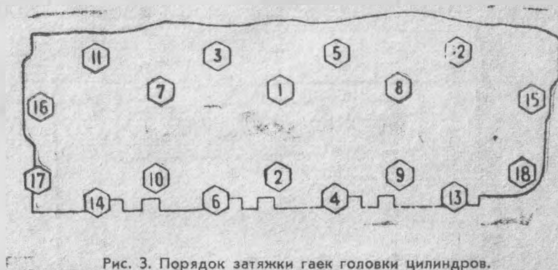
Рис. 3. Порядок затяжки гаек головки цилиндров.
