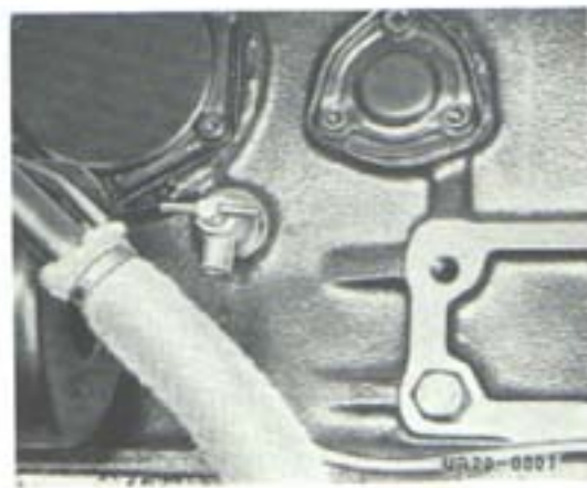
Fig. 61 Robinet de vidange sur moteur
