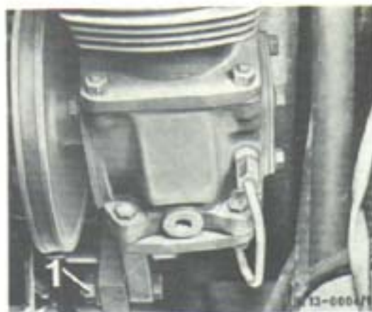
Fig. 89 Tension de la courroie trapézoïdale
