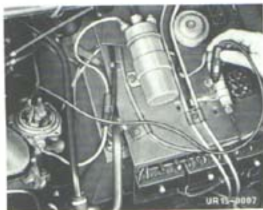
Fig. 46 Vérification de l'avance à l'allumage avec une lampe de contrôle 404.1
