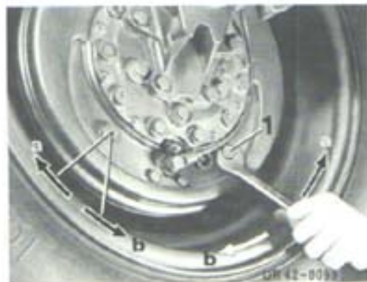
Fig. 81 Réglage des segments de freins 404.1
