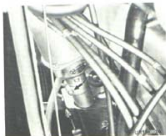
Fig. 47 Vis de blocage de l'allumeur
