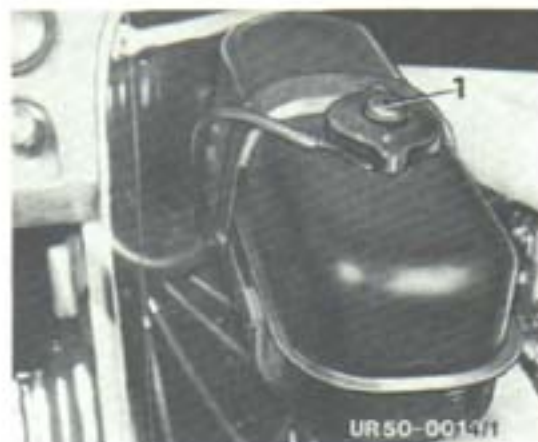
Fig. 58 Réservoir compensateur de réfrigérant
