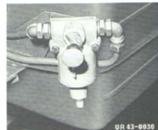
Fig. 92 Filtre avec prise de gonflage de pneus 404.1
