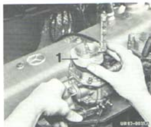
Fig. 53 Synchronisation des carburateurs
