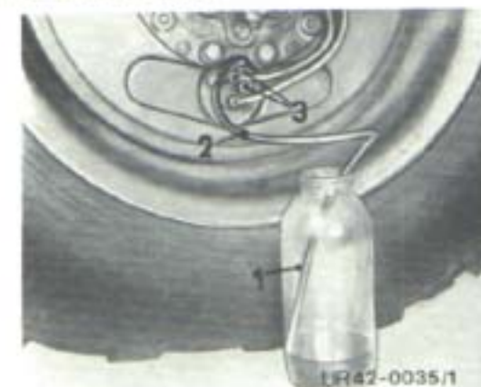
Fig. 79 Purge du système de freinage hydraulique
