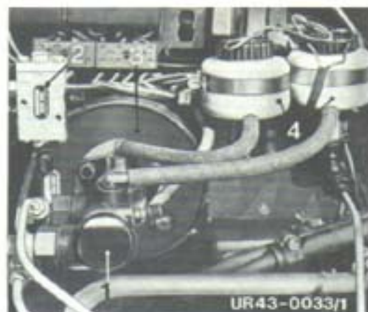
Fig. 94 Maître-cylindres de frein en tandem avec servofrein à air comprimé
