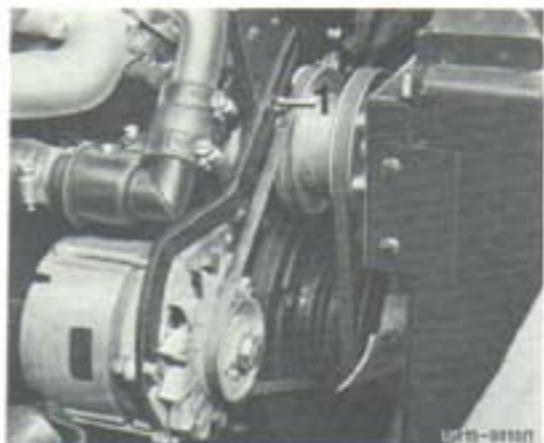
Fig. 63 Tension de la courroie trapézoïdale
