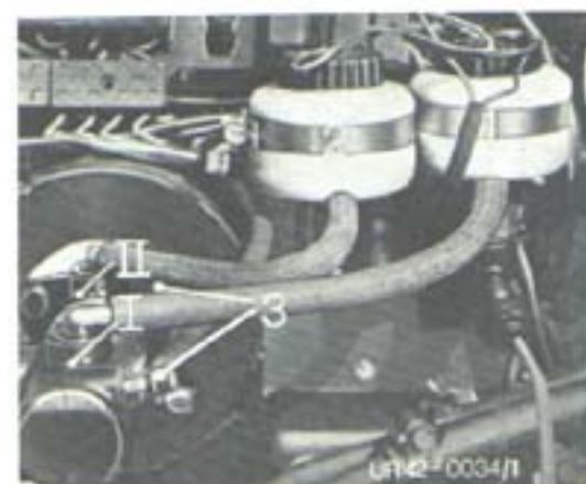
Fig. 76 Réservoirs de liquide de frein
