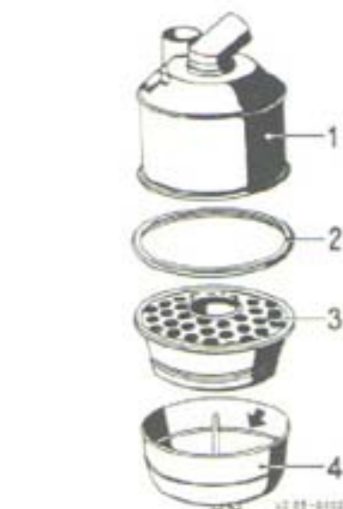
Fig. 43 Filtre à air à bain d'huile
