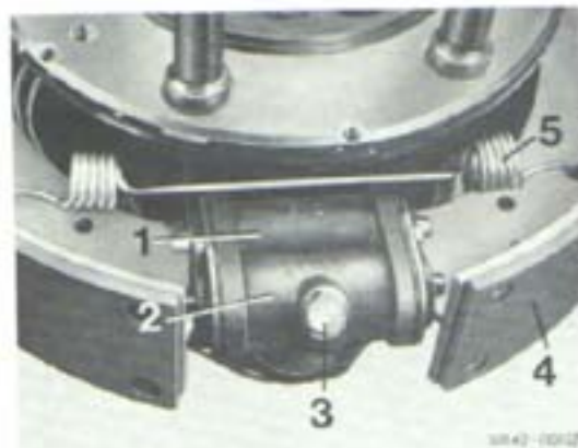
Fig. 76 Frein de roue AV avec cylindres jumelés
