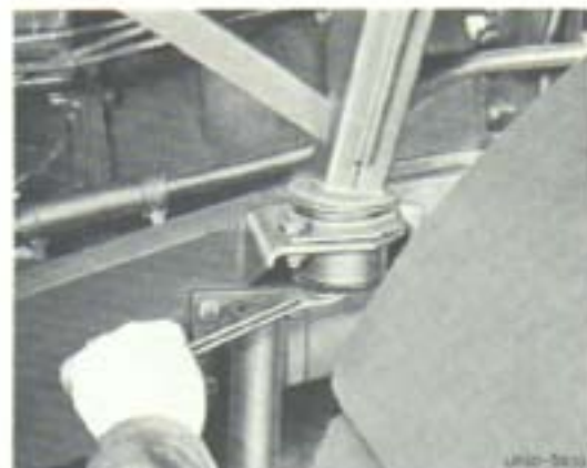
Fig. 105 Dévissage de la fixation AR de la cabine
